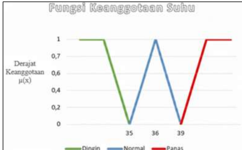
Gambar 5. Fungsi Keanggotaan Suhu Inkubator Telur [1]
